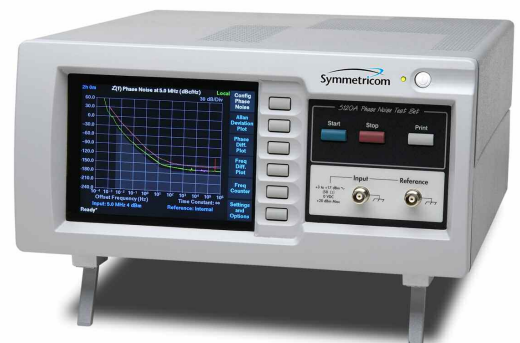
5120A. Высокоэффективный анализатор фазовых шумов и девиации Аллана с крайне низким уровнем шумов
