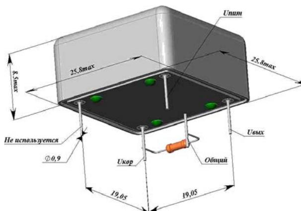
На чертеже указан технологический резистор (поставляемый с генератором) необходимый для установления частоты в номинал.
