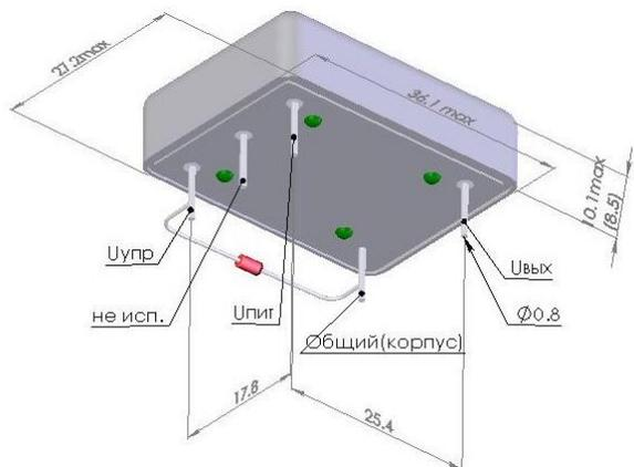
На чертеже указан технологический резистор (поставляемый с генератором) необходимый для установления частоты в номинал. Может быть перенесен заказчиком на печатную плату с сохранением номинала.
